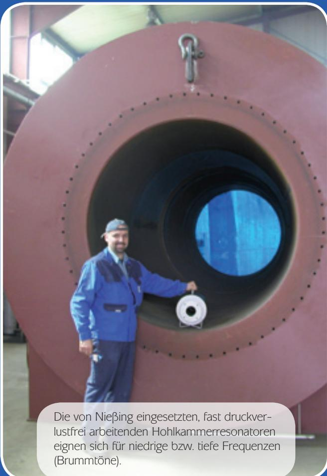
Die von Nießing eingesetzten, fast druckver-lustfrei arbeitenden Hohlkammerresonatoren eignen sich für niedrige bzw. tiefe Frequenzen (Brummtöne).
